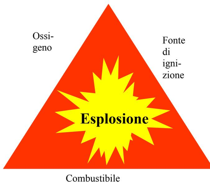
**Figura 1.2:** Il triangolo delle esplosioni
