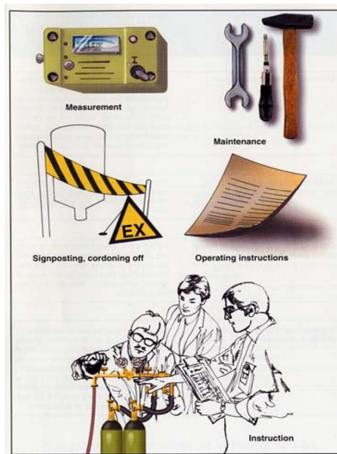
Figura. 4.1: Esempi di misure organizzative di protezione contro le esplosioni<sup>4</sup>.
