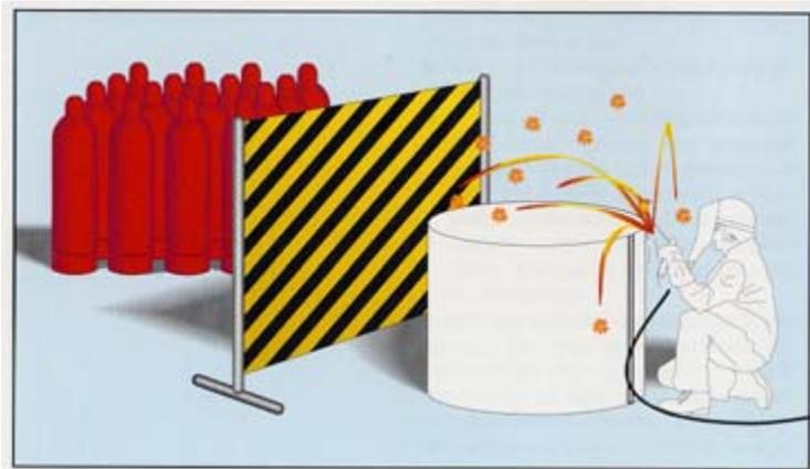
**Figura. 4.2:** Esempio di schermatura nel corso della produzione di scintille<sup>4</sup>
