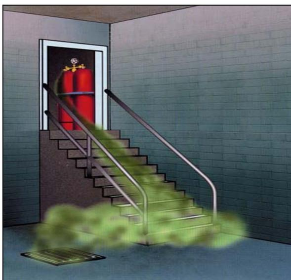
**Figura 2.3:** Modalità di propagazione dei gas liquefatti (esempio)<sup>4</sup>
