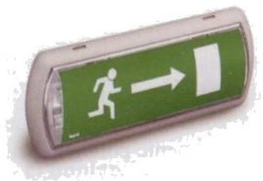
L'illuminazione di sicurezza deve fornire luce sufficiente durante l'evacuazione dei locali per una intensità di 5 lux (valore minimo), per una durata da 30 minuti a 3 ore, anche in caso di assenza di alimentazione elettrica generale. Esse sono poste in prossimità delle uscite di sicurezza, lungo le vie di esodo e i percorsi che conducono verso un luogo sicuro.
